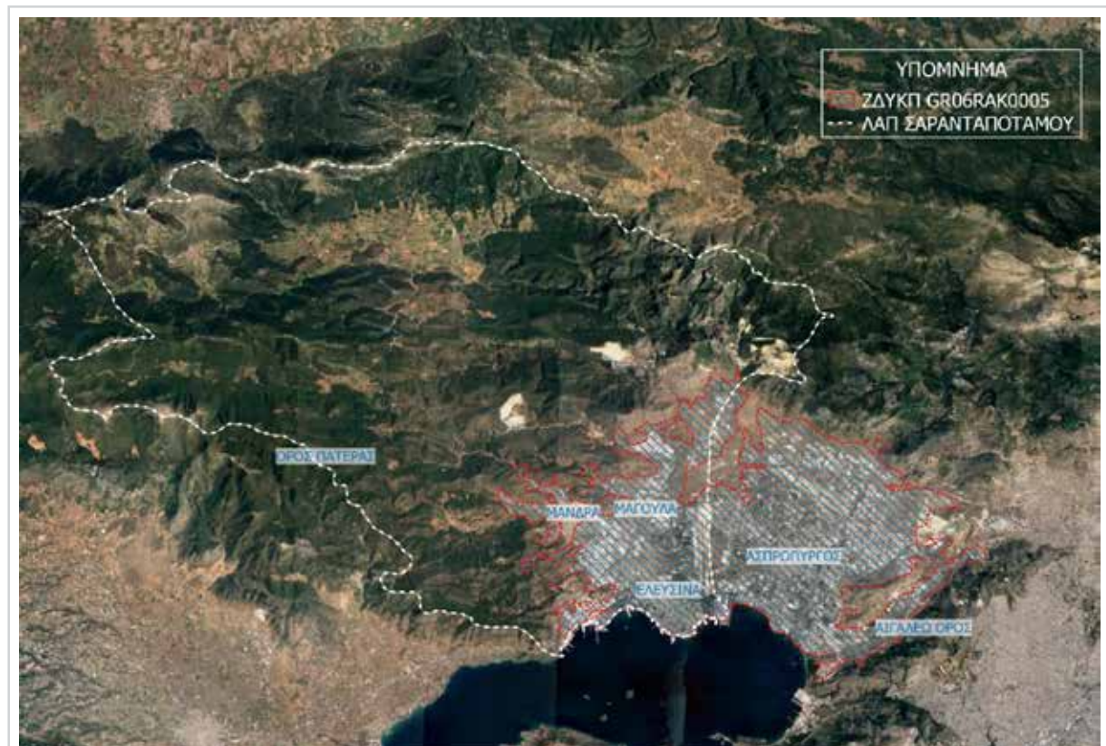
Εικόνα 8.1: Ζώνη Δυνητικά Υψηλού Κινδύνου Πλημμύρας «Χαμηλή Ζώνη Ασπρόπυργου – Ελευσίνας» (GRO6RAK0005) εντός της ΛΑΠ Σαρανταπόταμου (Υπόβαθρο: Google Satellite)
