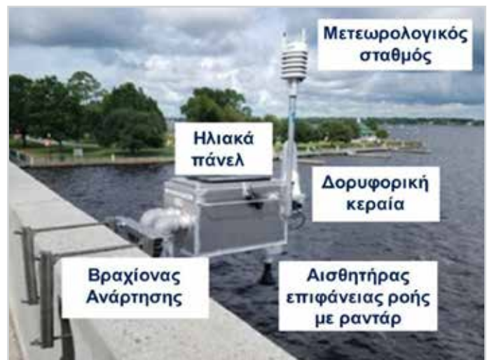
Εικόνα 3.6: Μετρητής στάθμης της επιφάνειας ροής με ραντάρ (Πηγή: USGS, 2021)
