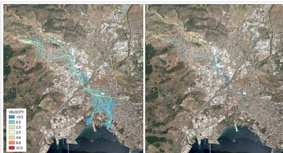
Εικόνα 8.58: Μέγιστες ταχύτητες ροής για τα ακραία σενάρια S200-18 (αριστερά, χωρίς τα έργα) και W200-18 (δεξιά, με τα έργα)
