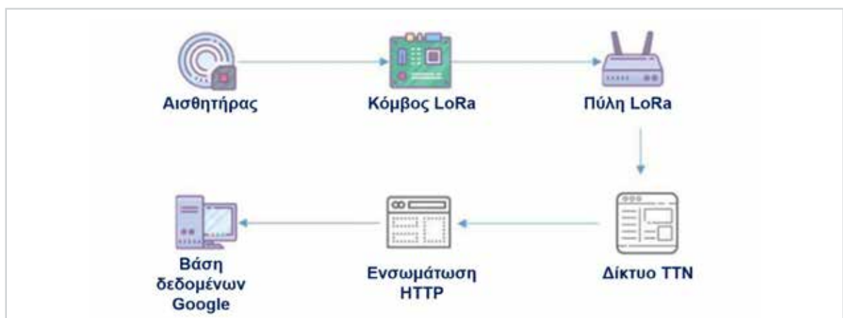
Εικόνα 6.10: Αρχιτεκτονική δικτύου με τυπική διάρθρωση μικτού περιβάλλοντος μετάδοσης δεδομένων NB-IoT και LoRaWAN
