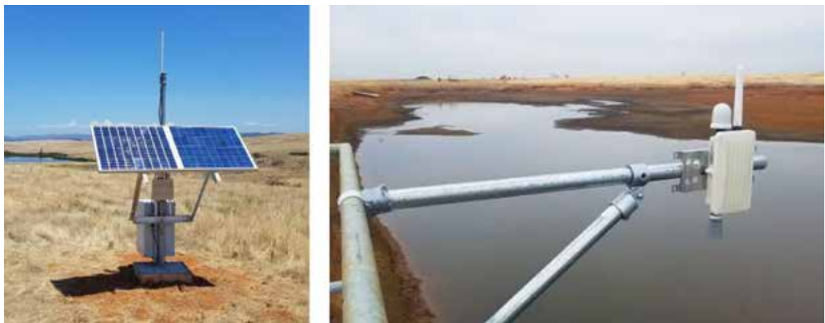
Εικόνα 6.9: Αυτόνομη (ενεργειακά) πύλη κινητής τηλεφωνίας (αριστερά) και ανέπαφος αισθητήρας μέτρησης στάθμης με ενσωματωμένο καταγραφέα/μεταδότη δεδομένων (δεξιά) (Πηγή: USGS, 2022)
