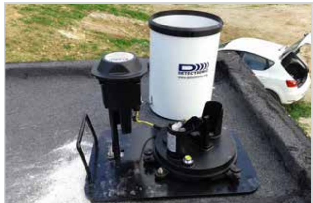
Εικόνα 3.3: Βροχογράφος με ανατρεπόμενο κάδο, καταχωρητή δεδομένων και δυνατότητα τηλεμετρίας μέσω GPRS (Πηγή: Detectronic, 2022)
