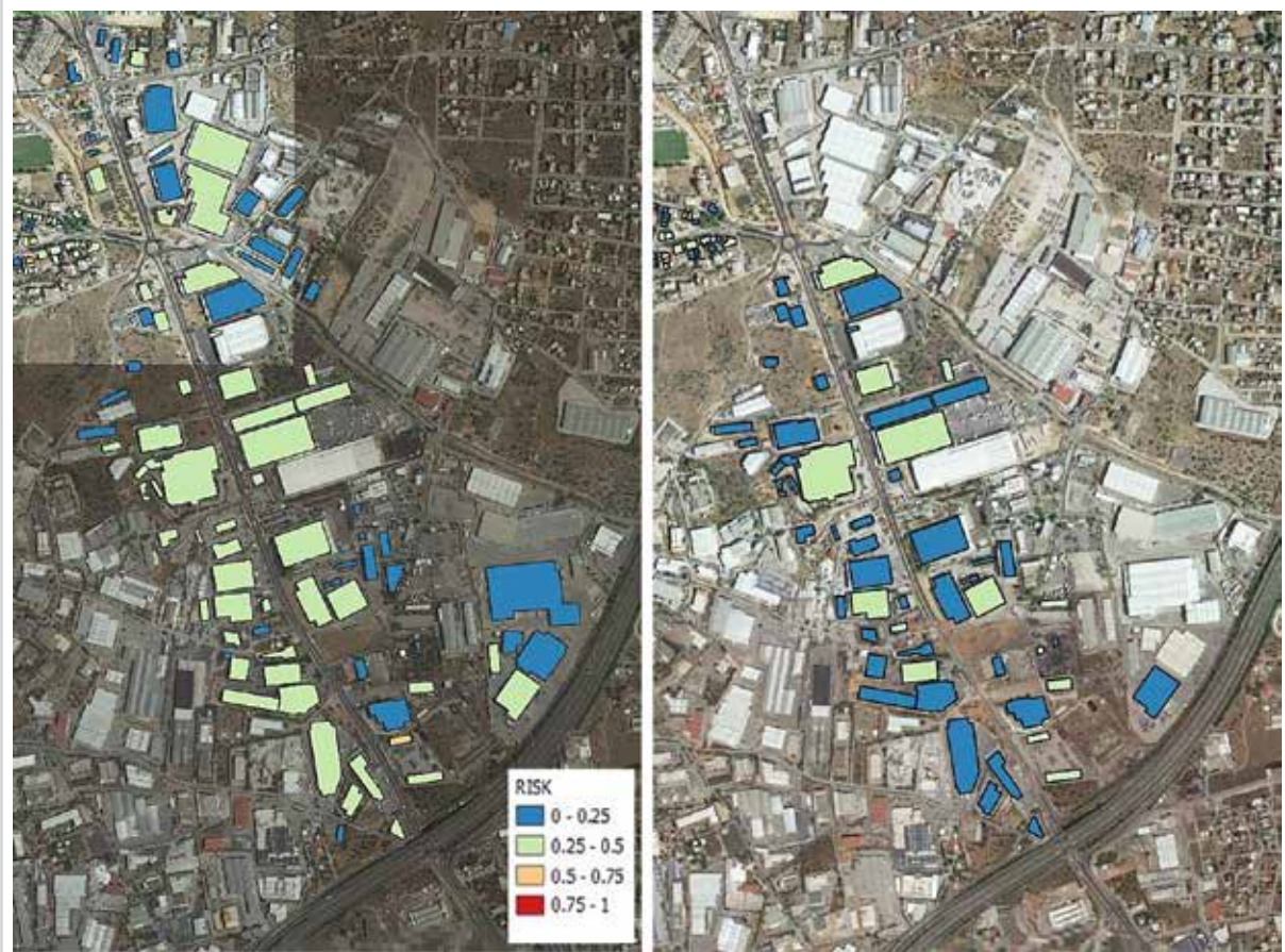
Εικόνα 8.63: Κίνδυνος πλημμύρας στη βιομηχανική περιοχή της Μάνδρας για τα ακραία σενάρια S200-18 (αριστερά, χωρίς τα έργα) και W200-18 (δεξιά, με τα έργα)
