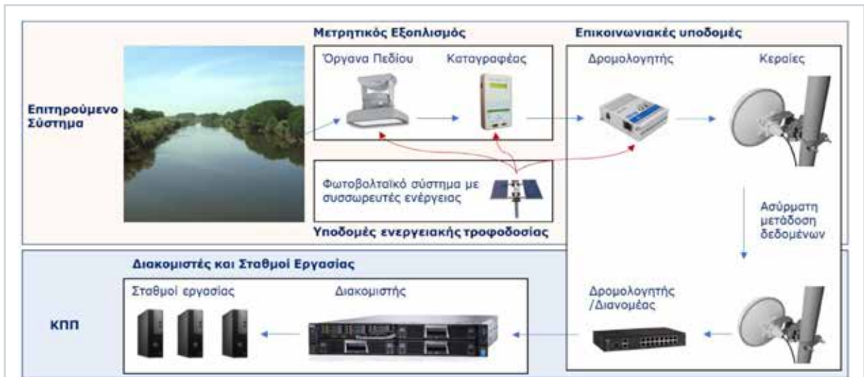
Εικόνα 6.1: Ενδεικτική διάταξη του εξοπλισμού ενός ΣΕΠΠ
