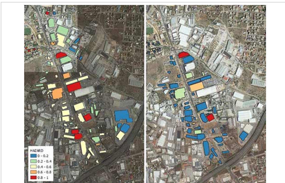
Εικόνα 8.60: Πλημμυρική επικινδυνότητα στη βιομηχανική περιοχή της Μάνδρας για τα ακραία σενάρια S200-18 (αριστερά, χωρίς τα έργα) και W200-18 (δεξιά, με τα έργα)
