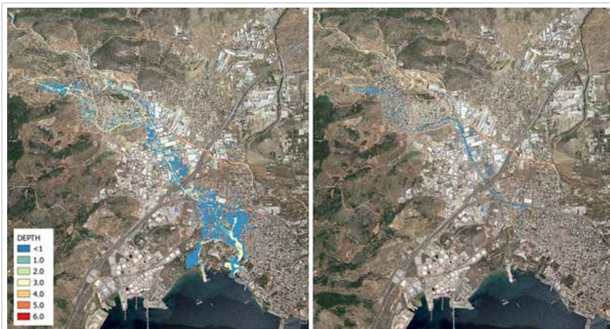
Εικόνα 8.57: Μέγιστα βάθη ροής για τα ακραία σενάρια S200-18 (αριστερά, χωρίς τα έργα) και W200-18 (δεξιά, με τα έργα)
