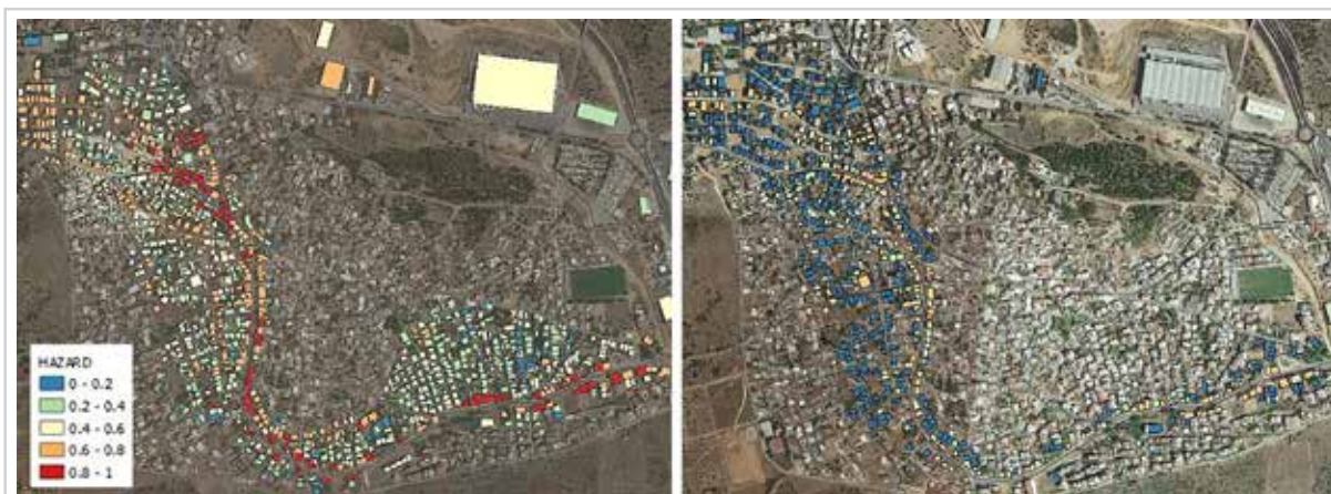
Εικόνα 8.59: Πλημμυρική επικινδυνότητα στην αστική περιοχή της Μάνδρας για τα ακραία σενάρια S200-18 (αριστερά, χωρίς τα έργα) και W200-18 (δεξιά, με τα έργα)
