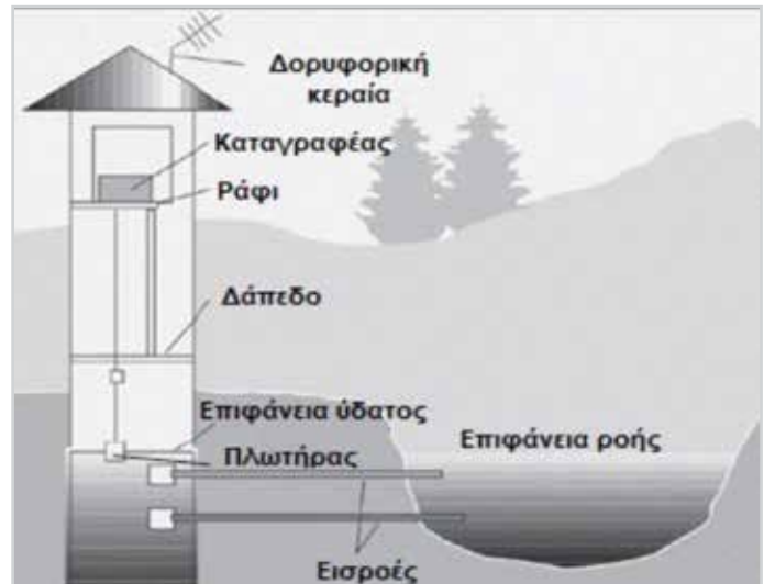
Εικόνα 3.4: Μετρητής στάθμης της επιφάνειας ροής με πλωτήρα (Πηγή: USGS, 2022a)
