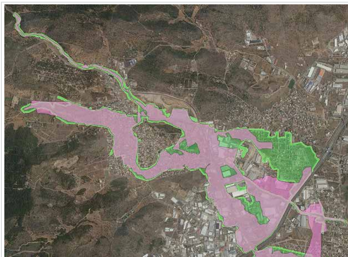
Εικόνα 8.53: Υπολογισθείσα περιοχή κατάκλισης κατά την πλημμύρα του 2017 χωρίς τα έργα (με πράσινο χρώμα) και με τα έργα (με ροζ χρώμα)
